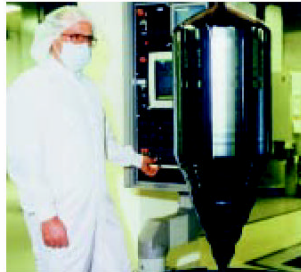
Siliciumeinkristall für Computerchips
